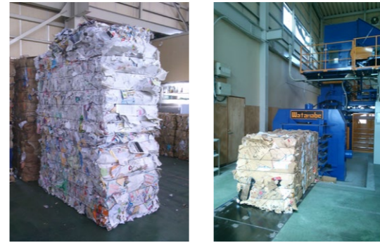
古紙用ラージペール仕様 圧縮力(tf):103 製品寸法(mm):1,000×1,100×自由 処理能力(t/h):10~12
