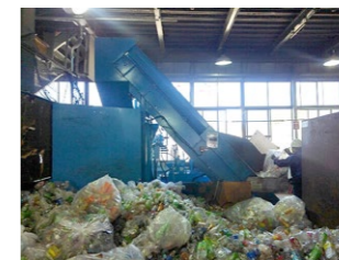
投入コンベア・シューターによる自動方式 加圧能力(t):32 外形寸法(幅×奥行×高さ):3045×2440×3290 処理能力(kg/h):400~450
